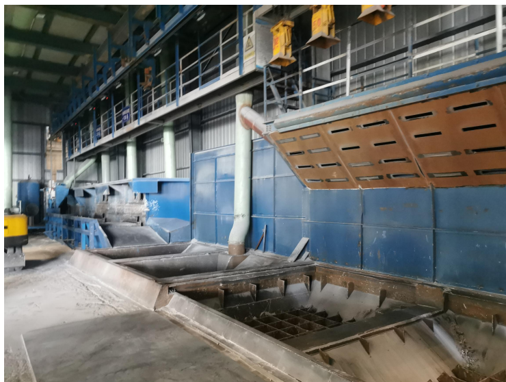
电解质清理工序及其集气设施
